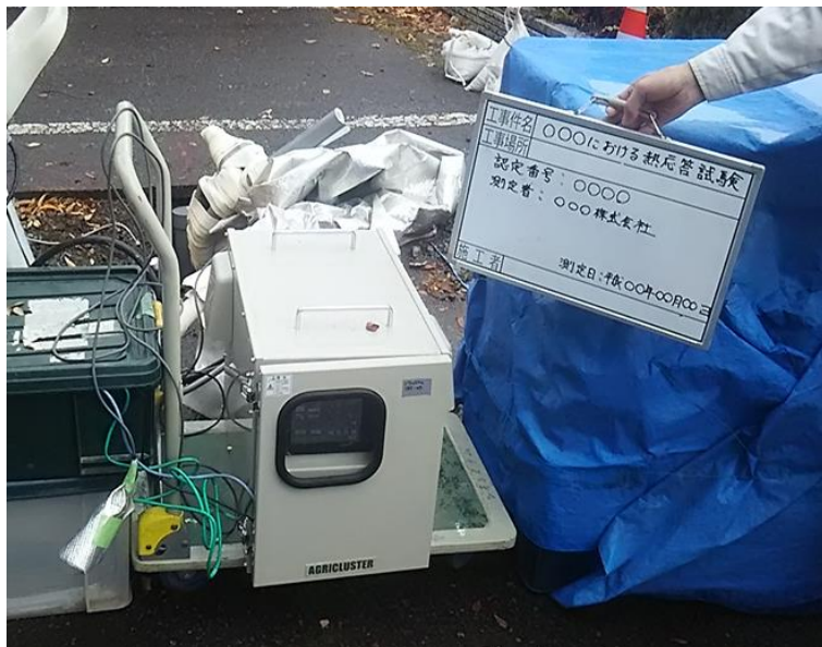
写真-2 TRT 測定装置写真 個体番号が写っていること
